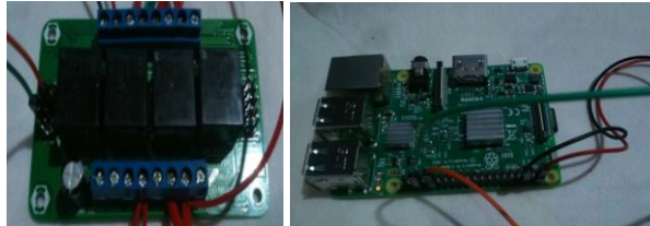
Gambar 5. Rangkaian DT-I/O Quad Relay Board dan Raspberry Pi 3
